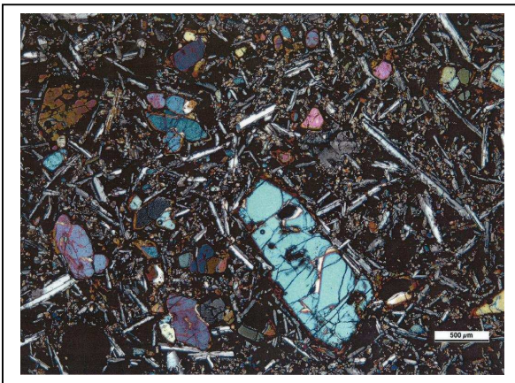
Alkali-Basalt aus dem Vogelsberg unter dem Polarisationsmikroskop
